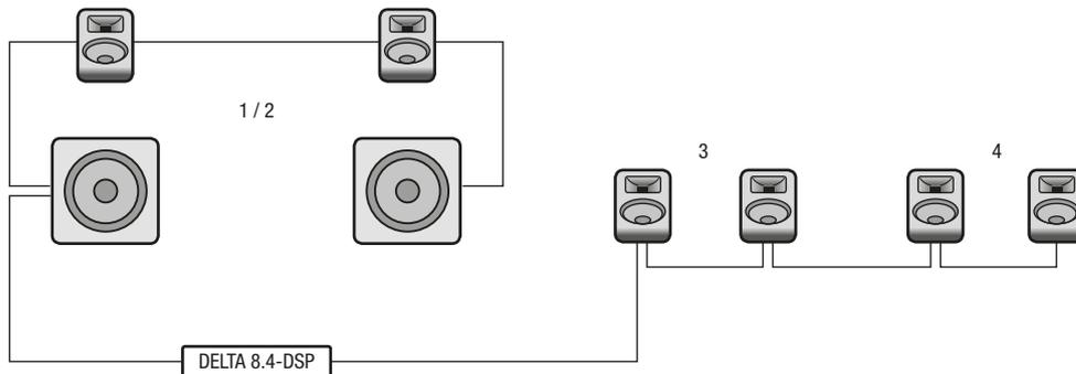
Die beiden Subwoofer und die Monitore werden über vierpolige Lautsprecherkabel verkabelt.
